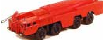
АА-60(7310)-160.01 аэродромный противопожарный автомобиль на шасси МАЗ/МЗКТ-7310;
