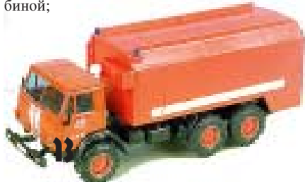
АР-2(43105)-215 автомобиль пожарный рукавный на шасси КамАЗ-43105 с дневной кабиной;
