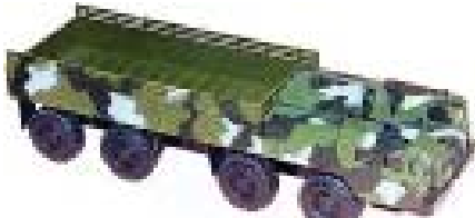
АА-60(7310)-160.01 аэродромный противопожарный автомобиль на шасси МАЗ/МЗКТ-7310;
