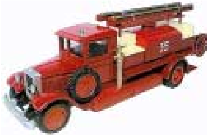
Пожарная цистерна ПМЗ-11 объемом 2 куб. м (ЛОМО-АВМ)
