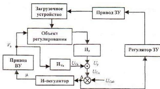
Рис. 1. Структурная схема комбинированной системы управления пневмотранспортированием
