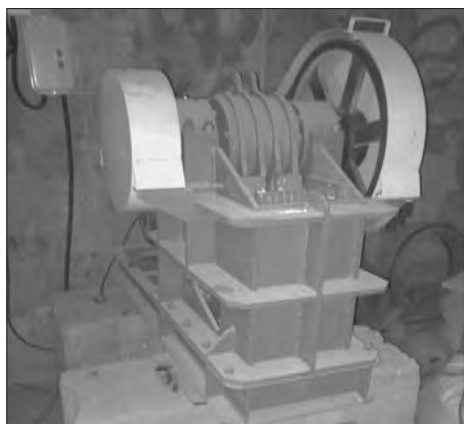
Рис. 2. Общий вид щековой дробилки ШДС 180×250 Fig. 2. General view of the jaw crusher SHCHDS 180×250
