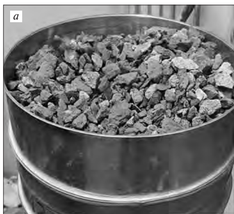
Рис. 3. Рециклинговый щебень из боя керамического кирпича: а – полученный из кирпичной кладки с раствором; б – полученный из кирпича без раствора Fig. 3. Recycled crushed stone from broken ceramic bricks: a – obtained from brickwork with mortar; b – obtained from brick without mortar
