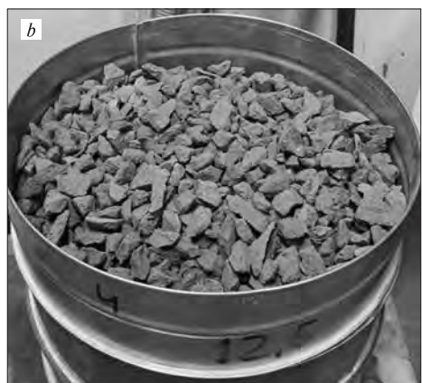
Рис. 3. Рециклинговый щебень из боя керамического кирпича: а – полученный из кирпичной кладки с раствором; б – полученный из кирпича без раствора Fig. 3. Recycled crushed stone from broken ceramic bricks: a – obtained from brickwork with mortar; b – obtained from brick without mortar
