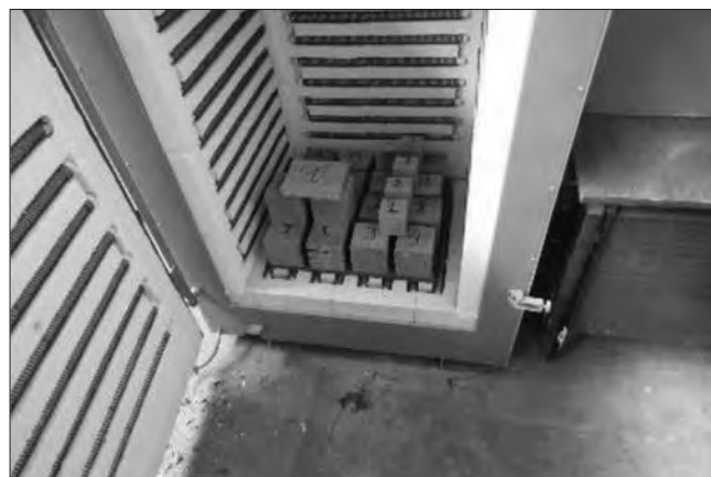
Рис. 1. Нагрев образцов в муфельной печи Fig. 1. Heating of samples in a muffle furnace
