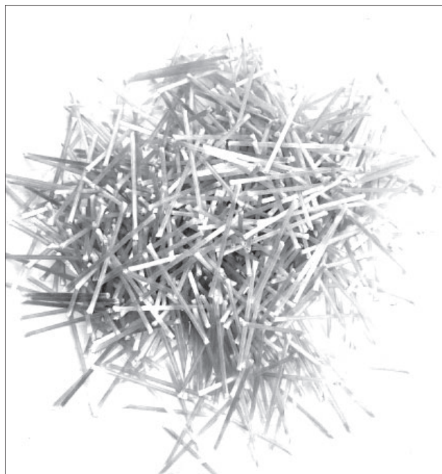
Рис. 1. Стеклопластиковая макрофибра ФСК Fig. 1. FSK fiberglass macrofiber
