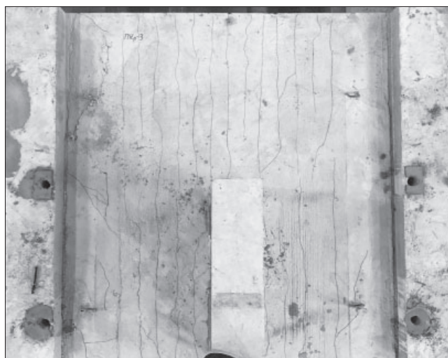
Рис. 8. Схема трещин на верхней поверхности плит. Образец ПКр-3
