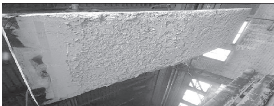
Рис. 5. Характерный вид обогреваемой бетонной поверхности контрольной серии плит после огневого испытания
