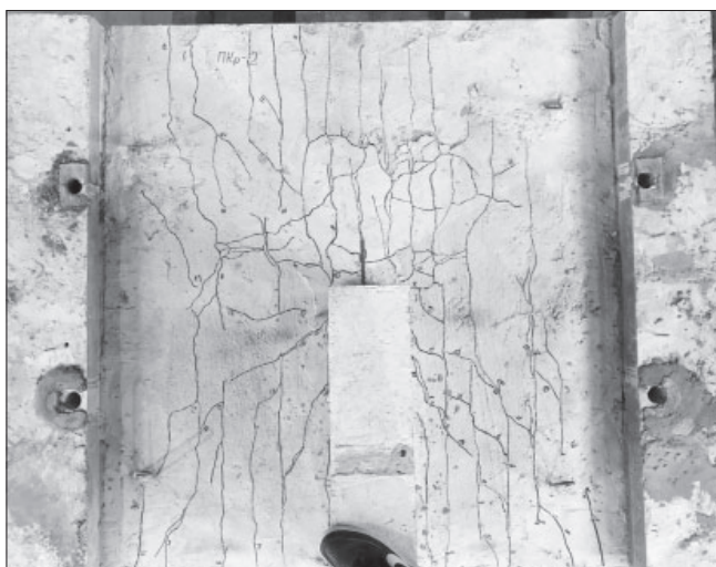
Рис. 7. Схема трещин на верхней поверхности плит. Образец ПКр-2
