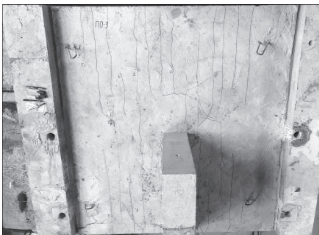
Рис. 5. Схема трещин на верхней поверхности плит. Образец ПО-3
