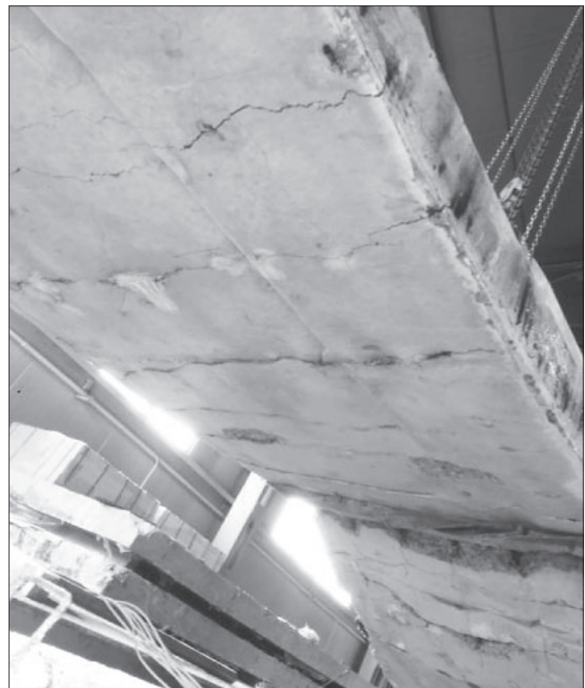
Рис. 11. Характерный вид плит серии Б после обрушения в пространство печи и после охлаждения Fig. 11. Characteristic view of series B slabs after collapse into the furnace space and after cooling
