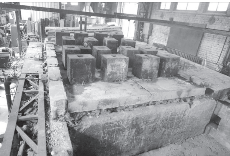
Рис. 2. Вид огневой установки и крупногабаритных плит, нагруженных равномерно распределенной нагрузкой, перед огневым испытанием
