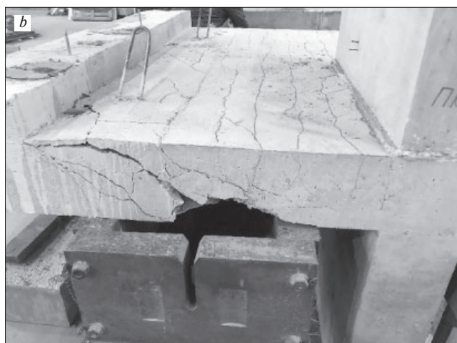
Рис. 9. Характер разрушения образца: а – опытный образец ПО-3; б – опытный образец ПКр-3
