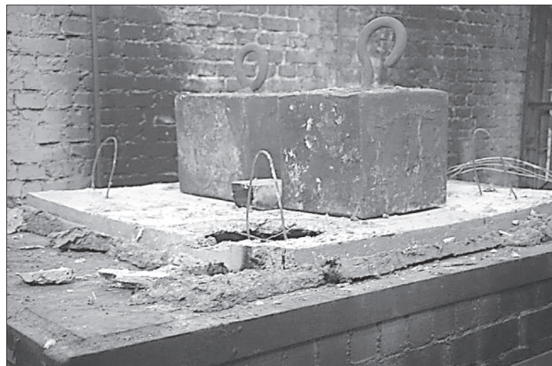
Рис. 3. Характерный вид образца № 1 малогабаритной тонкой плиты на огневой установке после огневого испытания
