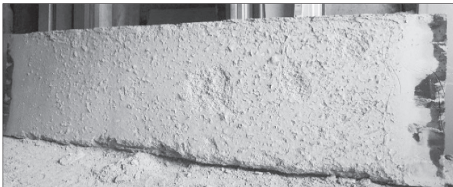
Рис. 4. Характерный вид обогреваемой поверхности крупногабаритной плиты из фибробетона после испытания
