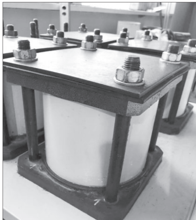
Рис. 2. Установленный образец под давлением во время испытаний, общий вид оснастки (нижний фланец, цилиндр, верхний фланец, резиновая прокладка, металлическая прижимная пластина, крепежные болты) Fig. 2. Installed sample under pressure during testing, general view of the tooling (lower flange, cylinder, upper flange, rubber gasket, metal pressure plate, mounting bolts)
