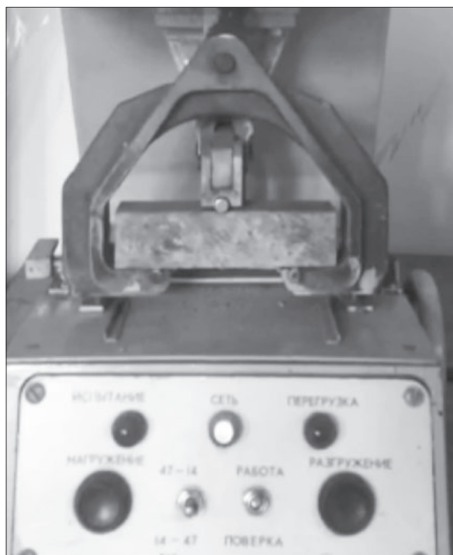
Рис. 1. Испытание образцов-балочек при изгибе Fig. 1. Bending test of beam samples
