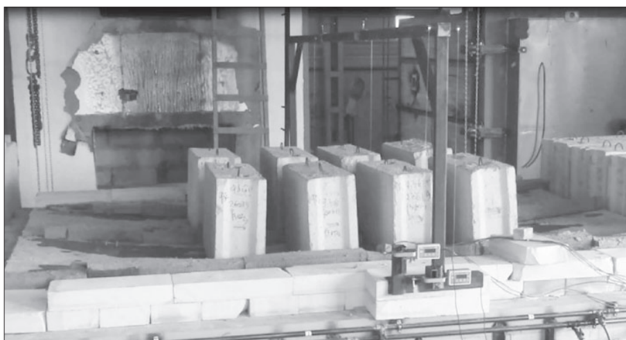
Рис. 9. Характерный вид нагруженных плит из фибробетона с ФКП на огневой установке в процессе огневого испытания
