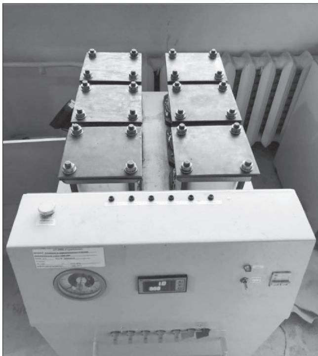
Рис. 1. Установка УВФ-6/09, производство ООО ИТЦ «Кон-трос», с установленными образцами во время испытаний Fig. 1. UVF-6/09 unit, manufactured by ITC «Kontros» LLC, with installed samples during testing
