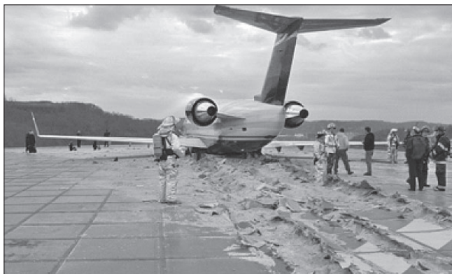
Торможение ВС на системе EMAS Aircraft braking on the EMAS system
