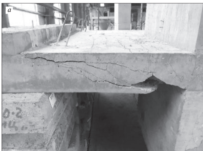
Рис. 9. Характер разрушения образца: а – опытный образец ПО-3; б – опытный образец ПКр-3
