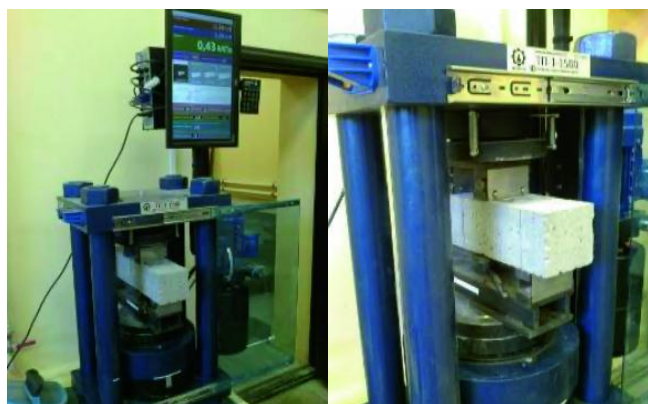
Рис. 2.3. Общий вид при испытании образца–призмы на растяжение при изгибе размерами 10 × 10 × 40 см Fig. 2.3. General view when testing of a 10 × 10 × 40 cm prism sample for tensile bending
