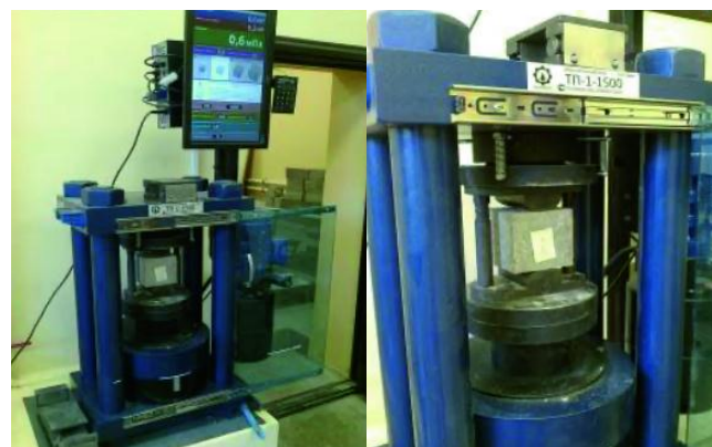
Рис. 2.4. Общий вид при испытании на раскалывание образца–куба размерами 10 × 10 × 10 см Fig. 2.4. General view during the splitting test of a 10 × 10 × 10 cm cube sample
