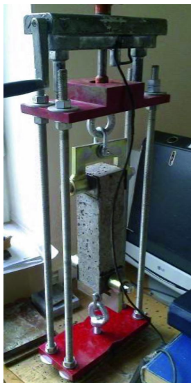
Рис. 2.1б. Общий вид при испытании на осевое растяжение образцов-призм размерами 7 \times 7 \times 28 см Fig. 2.1b. General view when testing for axial tension of a 7 \times 7 \times 28 cm prism samples
