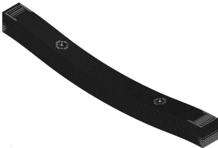
Рис. 5.17.7. Распределение напряжений \sigma_y (кН/см 2 ).
