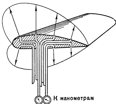
Рис. 23. Схема замера распределения давления по поверхности крыла.
