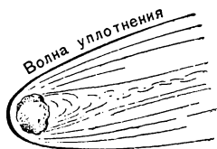
Рис. 97. Схема обтекания метеорита.
