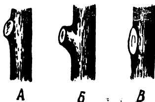
Рис. 18. Срез ветки «на кольцо»: А — правильный срез; Б и В — неправильные срезы.
