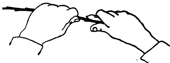
Рис. 66. Положение рук при косом срезе прививочного черенка; перед началом среза конец большого пальца правой руки отогнут.
