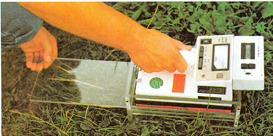
Измерение радиоактивности осуществляется так называемыми счетчиками Гейгера.
