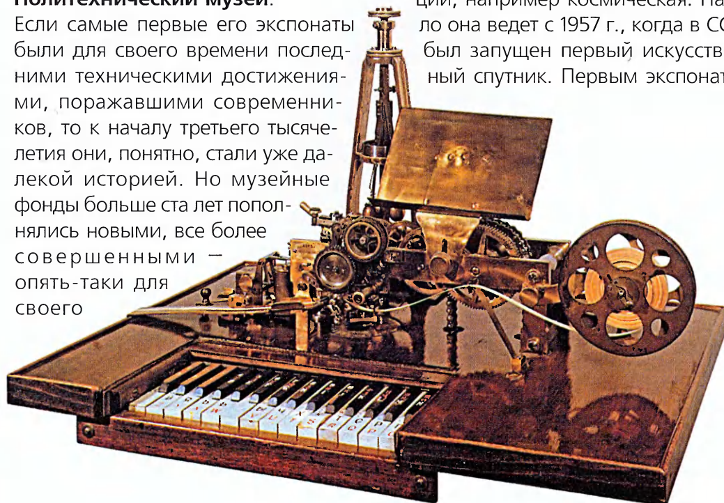
Буквопечатающий телеграфный аппарат (1855) английского изобретателя Дэвида Юза напоминает... рояль. Этот экспонат Политехнического музея относится к началу XX в.
