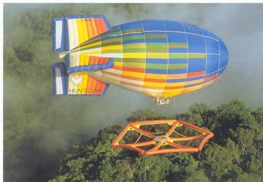
Изучать первый ярус тропического дождевого леса очень сложно. С помощью дирижабля монтируется сеть пластмассовых рукавов, которая служит ученым наблюдательной платформой.
