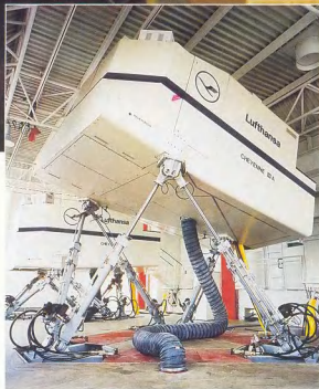
Летный тренажер похож на кабину настоящего самолета. Пилоты учатся управлять машиной в экстремальных условиях или выполнять посадку на незнакомом аэродроме. Компьютер имитирует движение самолета, управляет приборами, создавая обстановку реального полета.
