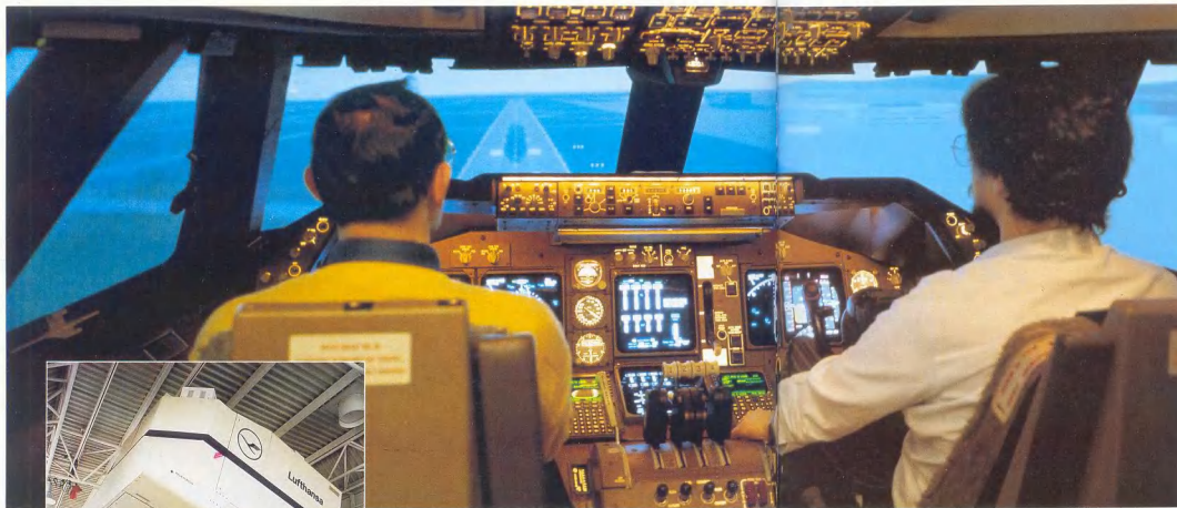
Летный тренажер похож на кабину настоящего самолета. Пилоты учатся управлять машиной в экстремальных условиях или выполнять посадку на незнакомом аэродроме. Компьютер имитирует движение самолета, управляет приборами, создавая обстановку реального полета.
