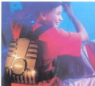
Электронный костюм для виртуального бокса. Специальные датчики имитируют ощущение удара.
