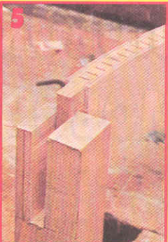
Гребень гнутых царг должен быть равен половине длины паза ножки. Широкая щель между ними не допускается.
