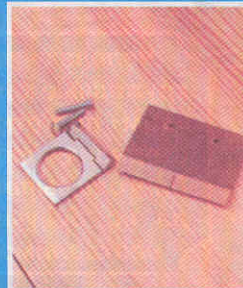
С помощью шаблона размечаются отверстия для шурупов, которыми прикрепляются ручки. Ручки следует ставить посередине откидной дверки шкафа.
