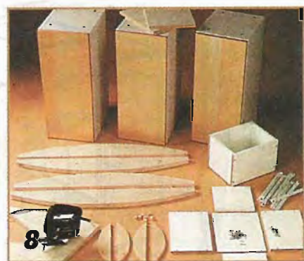
8 Все необходимые для изготовления серванта детали, в частности, боковые опоры-ножки, горизонтальные щиты, ручки-планки и дистанционные прокладки выкраивают электролобзиком.
