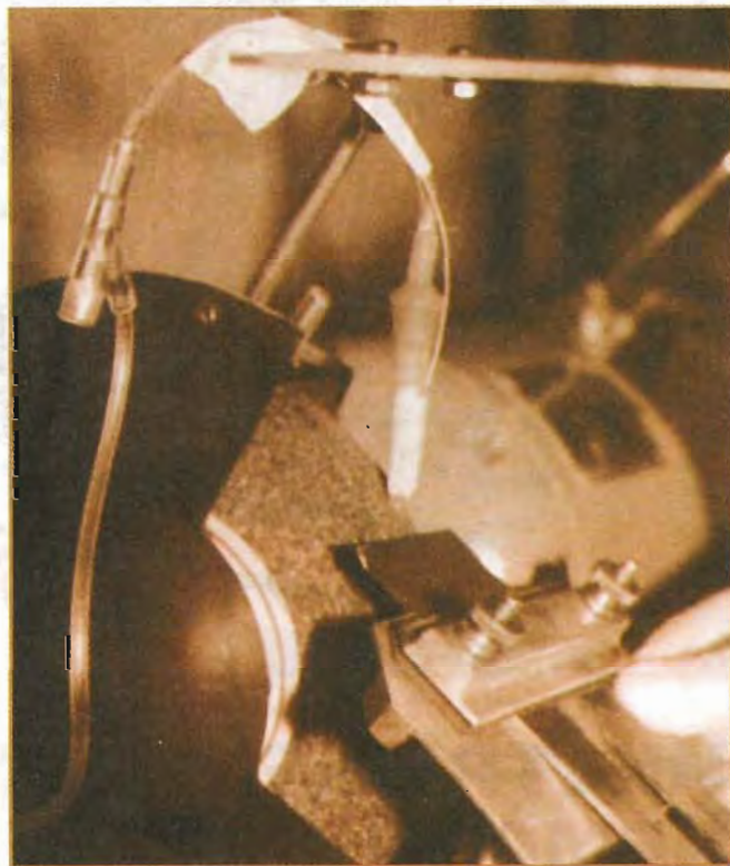
Водяное охлаждение при заточке можно использовать на новых кругах со связкой из шеллака и кругах, изготовленных методом спекания.
