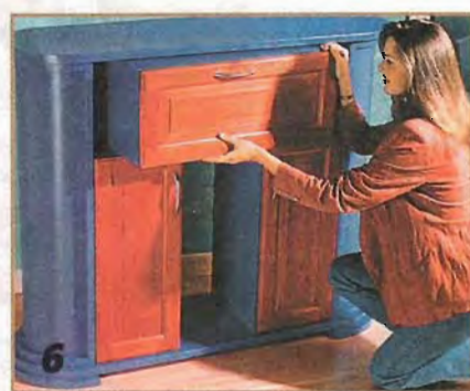
6 Колонны имеют сверху и снизу расположенные ступенчато полукруглые плиты. В раму, которую образуют горизонтальные щиты и боковые стенки с колоннами, вставляют три кухонных шкафчика, оставляя между ними зазор шириной 5 мм.
