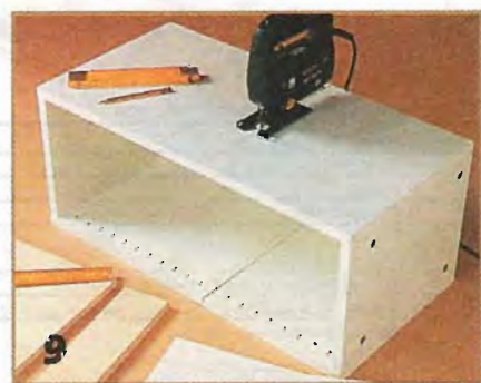
9 Из средней части одного из подвесных шкафчиков вырезают полосу шириной 100 мм, получая таким образом два ящика высотой 300 мм.
