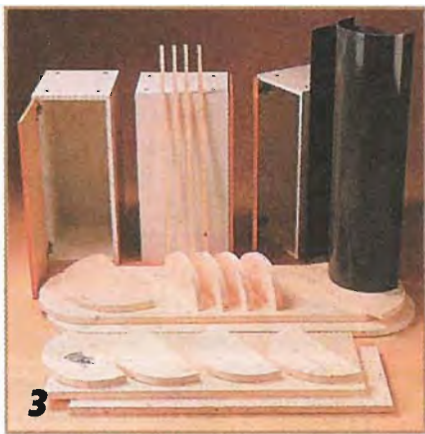
3 Сначала выкраивают электролобзиком все приведенные в перечне детали. Особое внимание следует уделить раскрою полукруглых плит.
