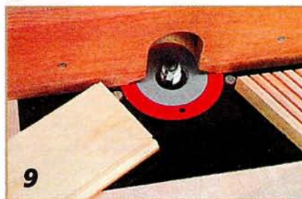
9 Законченное ступенчатое соединение и секция доски готовы к отпиливанию по длине и установке в задние перемычки.
