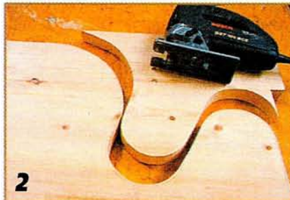
2 Деталь выпиливают по контуру с 3-мм припуском.
