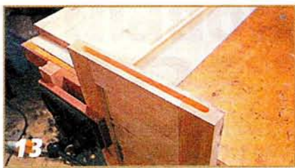
13 Паз в боковой панели для свободного шипа.
