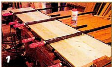
1 Заготовку склеивают и, зажав струбцинами, просушивают.
