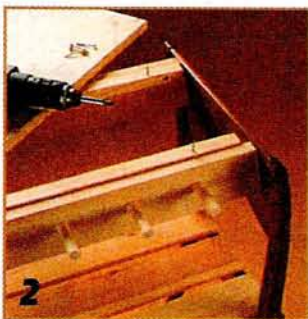
Для крепления шкантов-крючков в одной из верхних продольных царг сверлят отверстия Ø16 мм и глубиной 10 мм.
