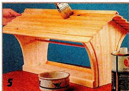
Прикрепив к верху кровли конек, кормушку дважды покрывают прозрачным лаком.
