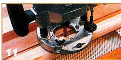
11 Один из пазов выбирают с помощью двухступенчатой направляющей.
