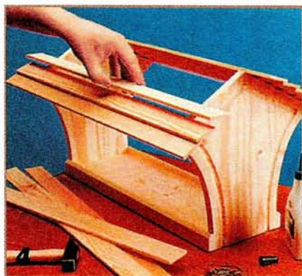
Планки крыши крепят на гвоздях. Ширина свеса нижних планок — 20 мм. Их крепят с напуском друг на друга. Ширина напуска — 10 мм.
