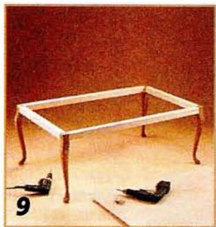
9 Ножки стульев крепят к раме на клею и шурупах (см. рис. 2).
