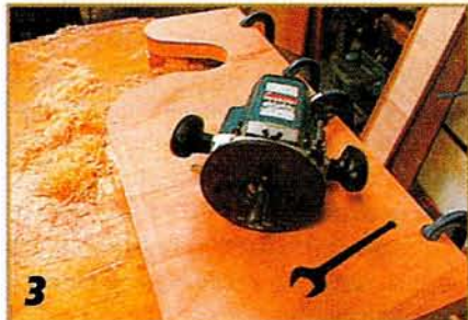
3 При обработке шаблон прочно прижимают к детали.
