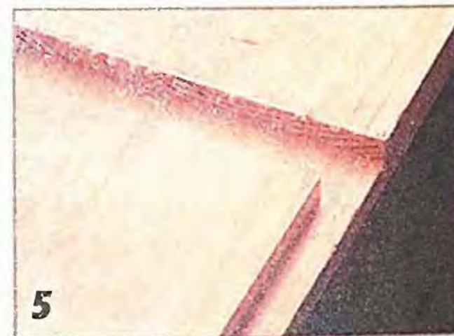
Не забудьте — четверть заканчивается у нижней полки.
