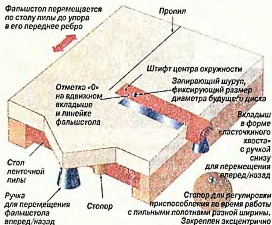
Рис. 2. Приспособление для выпиливания дисков.
