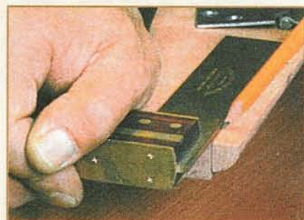
Ось петли лежит в одной плоскости с губкой.
