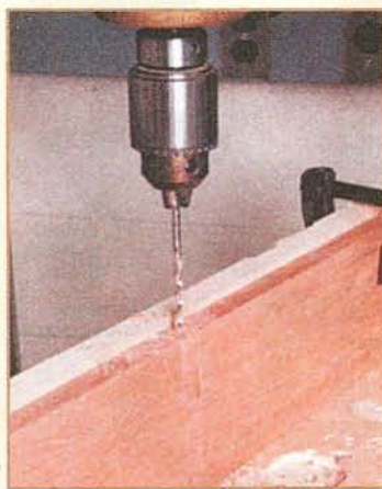
Сверление сборки петли.
