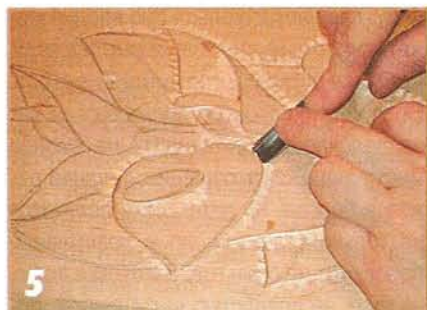
5 Полукруглой стамеской подрезаем рисунок по контуру, учитывая взаимное расположение элементов по глубине. Подготавливаем поверхности листьев для окраски или дальнейшей детализировки.
