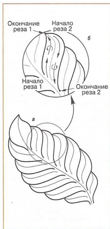
Рис. 2. Схема детализировки «перистого» листа: а — ножом надрезаем лист по рисунку, стараясь не перерезать центральную жилку; б — каждый отдельный листочек подрезаем за два прохода: 1 — установив полукруглую стамеску среднего диаметра в точке «начало реза 1», ведём её левым краем вдоль линии надреза к точке «конец реза 1», разворачивая вокруг оси влево примерно на 30°; 2 — развернув доску на 180°, повторяем движение от точки «начало реза 2» до точки «конец реза 2». Закончив одну сторону листа, делаем то же с другой стороны, но разворачивая стамеску по оси вправо.
