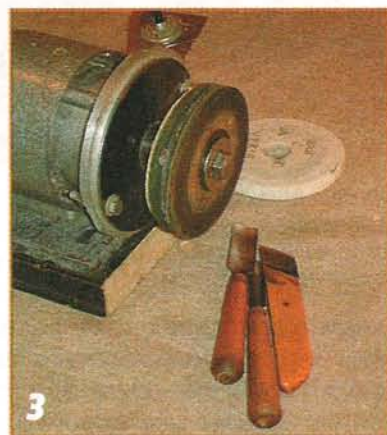
Перед работой нож и стамеска должны быть наточены. Во время работы их следует периодически доводить на войлочном или кожаном кругах.
