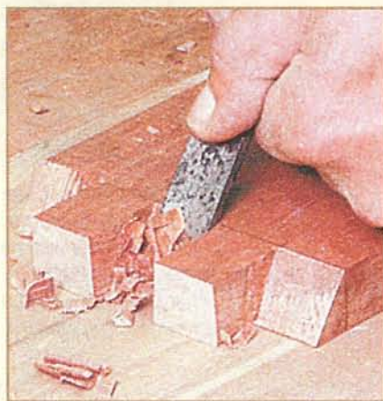
Чтобы петля свободно вращалась, задние части шарниров поднутряют.
