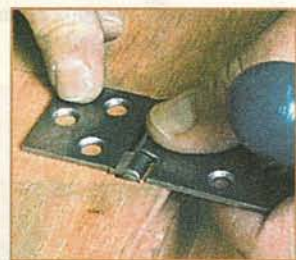
Сначала я выбрал паз под цилиндр. Затем обвёл карты и выбрал гнёзда так, чтобы карты были заподлицо с крышкой.
