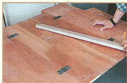
Рис. 3. Эlegantную скруглённую крышку любого размера можно разметить из разных центров с помощью «штангенциркулей» и циркуля. Скругления заканчиваются у угловых выкружек, прямые участки которых совпадают с ножкам.
