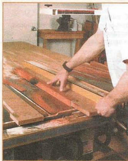
Два первых продольных запила в приспособлении.
