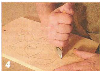
4 После нанесения рисунка надрезаем контур, держа нож вертикально
