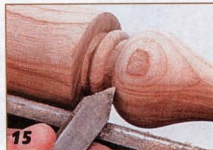
15 Отрезным резцом или стамеской скругляют рёбра.
