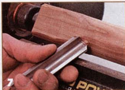
7 При точении цилиндра инструмент направляют пальцами.
