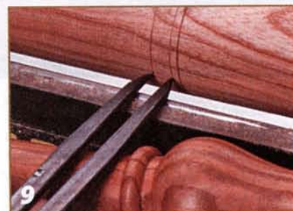
9 Желательно не откладывать размеры последовательно.
