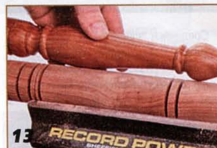
13 Осматривают заготовку и сравнивают её с оригиналом.
