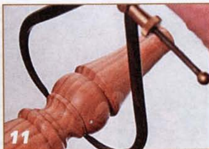
11 Устанавливают кончики ножек кронциркуля так, чтобы между ними проходил диаметр.
