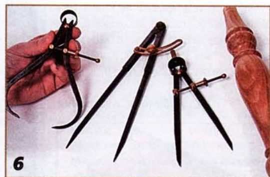
6 Лучше работать кронциркулями с фиксаторами.
