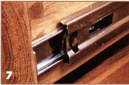
7 При полностью выдвинутых «салазках» легко добраться до всего содержимого. Такие механизмы идеально подходят для кухонной мебели.
