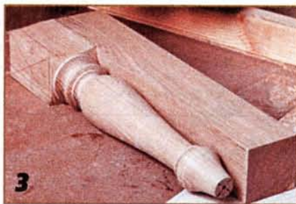
3 Концы заготовок одинаковой длины могут использоваться как опорные поверхности.
