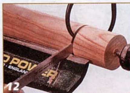
12 Отрезным инструментом заготовку протачивают до диаметра, которому соответствует положение ножек кронциркуля.
