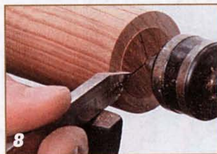
8 Тончайшими проходами обтачивают торцы.
