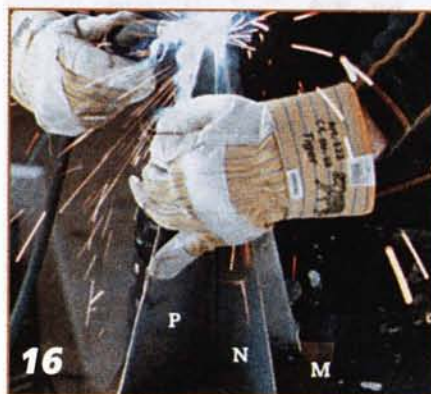
16 Треугольные пластины P и N приваривают с другой стороны подпятника M .
