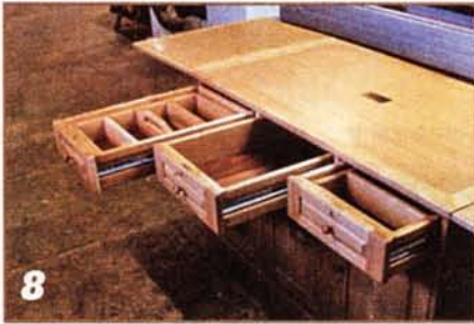
7 При полностью выдвинутых «салазках» легко добраться до всего содержимого. Такие механизмы идеально подходят для кухонной мебели.
