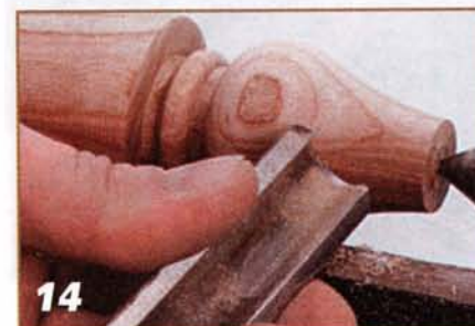
14 Чтобы закончить контур, соединяют опорные точки.
