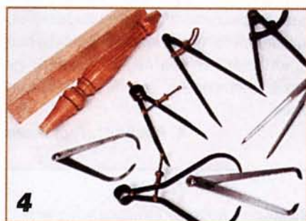
4 Растворы кронциркулей, соответствующие характерным диаметрам детали, стараются не сбивать.
