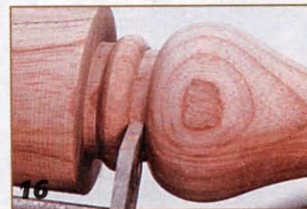
16 Для облегчения копирования точат заплечики шириной, равной ширине отрезного инструмента.
