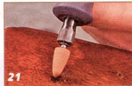
21 Шлифуют поверхность прожога вплоть до его краёв. Наносят на это место акриловый лак заподлицо с поверхностью мебели.
