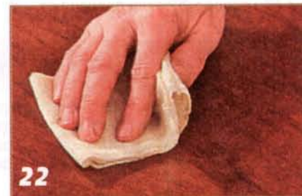
22 Чистят остальную поверхность специальной тканью, к которой липнут даже мельчайшие частички пыли.
