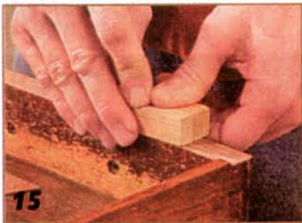
15 Наглаженный шпон куском дерева крепко прижимают к основе. Свесы шпона удаляют стамеской.
