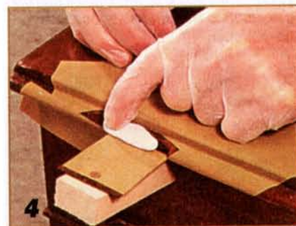
5 Разминают пальцами кусочек двухцветной массы до тех пор, пока она не станет белой. За 5 мин необходимо заполнить ею повреждённое место вплоть до последнего уголка.
