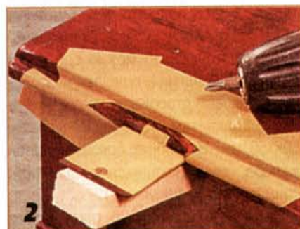
2 Упаковочной лентой обклеивают также шарнирную карту петли и среднюю часть оси её поворота и закрепляют маленьким шурупом петлю на кусочке древесины.
