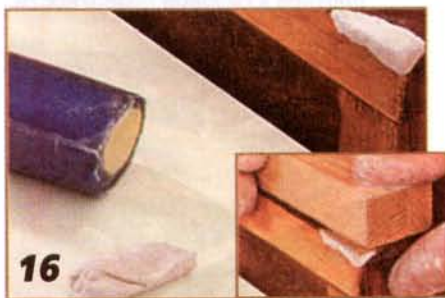
16 Вдавливают вырезанный за повреждённым местом шпон в двухкомпонентную массу.
