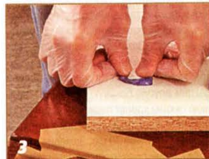
4 Надев латексные перчатки, отрезают кусочек двухкомпонентной ремонтно-клеящей массы.
