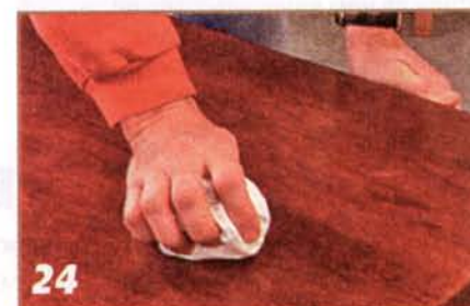
24 Затем полируют поверхность сухой хлопчатобумажной тряпкой до зеркального блеска.
