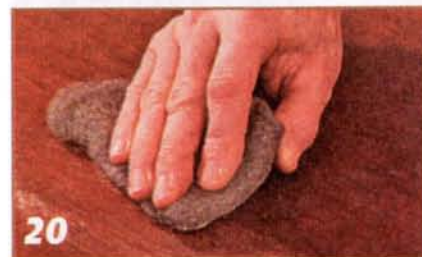
20 Осторожно обрабатывают образовавшиеся от влаги пятна и другие дефектные места металловолоконистой шкуркой, совершая ею движения в направлении линий текстуры.
