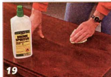
19 Тщательно протирают место прожога денатуратом, чтобы растворить слои старой политуры и одновременно сгладить мелкие царапины.
