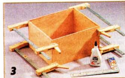
3 Подготовленные к сборке детали корпуса соединяют на клею, обеспечивая прямоугольность соединений.
