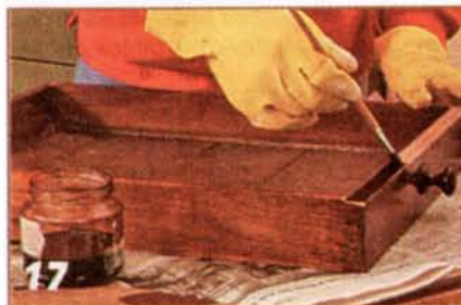
17 Прежде чем нанести разведённую на спирту порошкообразную морилку, её опробывают на обрезках шпона.
