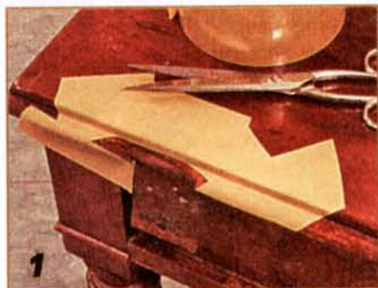
1 Место скола древесины тщательно обклеивают упаковочной лентой.
