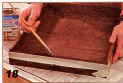
18 Обклеивают залатанное место упаковочной лентой. Наносят первый слой акрилового лака, дают ему высохнуть, затем аккуратно, чтобы не затронуть морилку, шлифуют и наносят второй слой лака.
