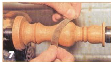
Плавные переходы и выпуклые фрагменты шлифуют ленточкой шкурки.
