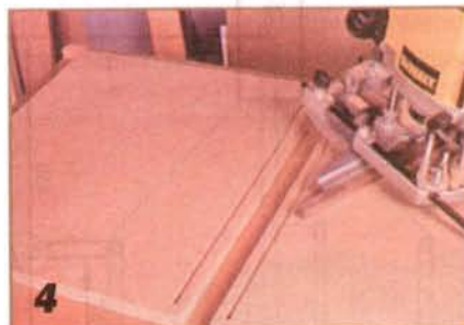
Торцевые стенки и глухие пазы для дна фрезеруют с такой же установкой фрезерной машинки, как при выборке пазов на боковых стенках.
