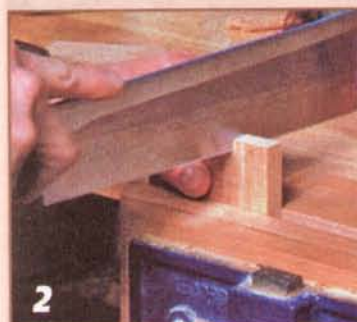
2 Первый рез делают до половины ширины заготовки.
