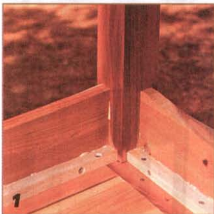
Рейки крепления проножек с крышкой стола.
