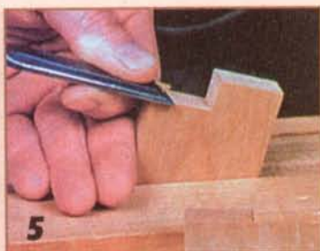
5 Контактующие поверхности соединений зачищают стамеской.
