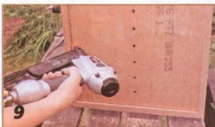
Дно крепят шурупами к центральной перегородке, а к боковым и торцевым стенкам — под углом забитыми 20-мм штифтами.
