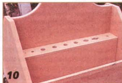
Полку для стамесок и других, подобных по форме инструментов, делают из 12-мм ДВП. Для комплекта стамесок и других острых или часто используемых инструментов сверлят отверстия.
