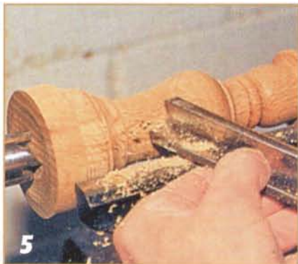
При проработке деталей в средней части подсвечника большую часть древесины снимают черновым полукруглым резцом.
