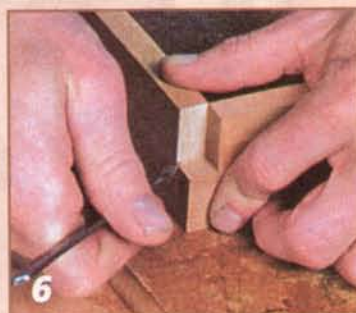
6 Ответный шип размечают «по месту» — по выпиленному заплечику.
