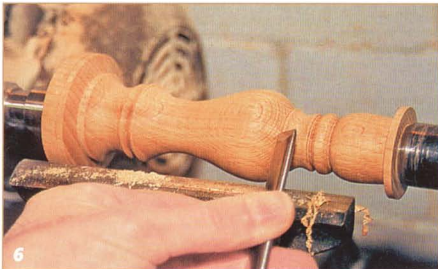
Окончательную обработку поверхности и проработку мелких деталей выполняют косым чистовым резцом.
