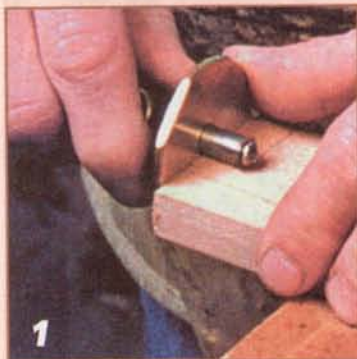
1 Разметка соединений вполдерева.
