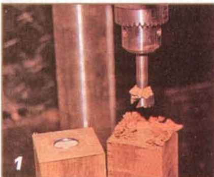
Глухие «гнезда» для свечей в заготовках высверлены на сверлильном станке.
