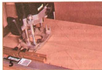
Вертикальный паз для перегородки фрезеруют с помощью приспособления «точная направляющая».
