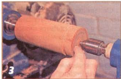
Косым резцом подправляют основание и выбирают в его центральной части небольшое углубление, чтобы готовый подсвечник ровно стоял на любой гладкой поверхности.
