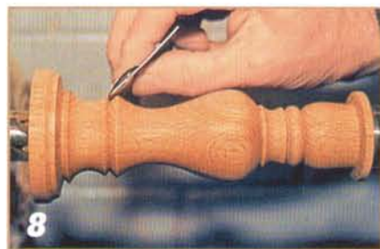
При шлифовании поверхности в узких кольцевых вырезах и углах в качестве оправки для шкурки можно использовать пластиковую кредитную карточку.
