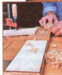
10 Крышка зафиксирована верстачным упором и струбциной с прокладкой.
