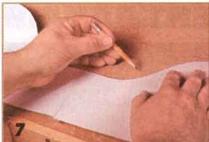
Разметку верхней стороны перегородки делают по картонному шаблону.
