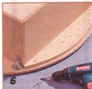
Снизу к нижнему горизонтальному щиту привинчивают дистанционную доску.
