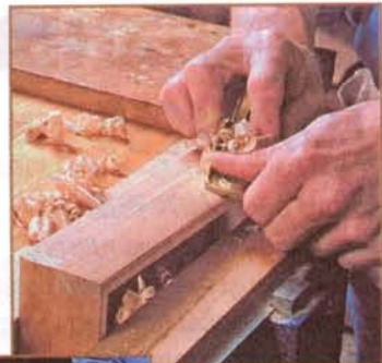
9 Скругление боковых стенок коробки.
