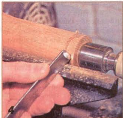
Перевернув заготовку, вокруг «гнезда» для свечи осторожно вытачивают «ловушку для воска».
