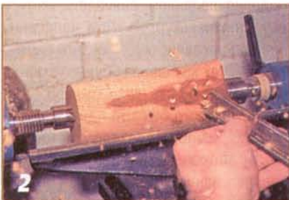
Обработка заготовки до цилиндрической формы черновым полукруглым резцом. При резании полукруглым резцом его нужно повернуть чуть-чуть на бок так, чтобы желобок был направлен по ходу резца.
