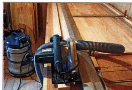
Продольная распиловка. Чтобы направляющая не прогнулась, в центре её подпирают обрезком профиля
