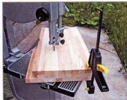
С криволинейными деталями успешно справляется ленточная пила
