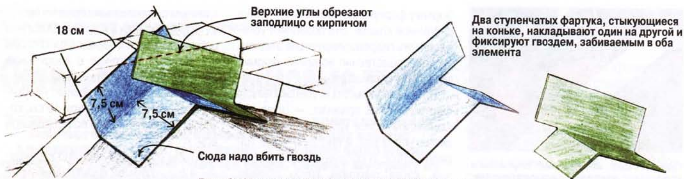
Рис. 2. Сопряжение фартуков на коньке крыши
