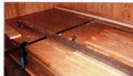
Положение подвижного упора задают с помощью линейек
