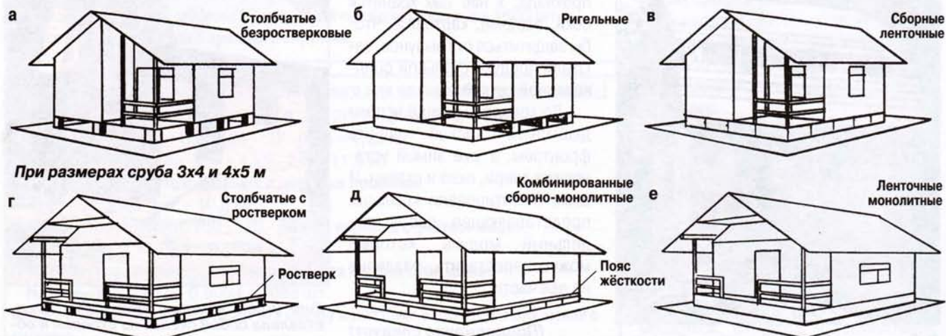
Рис. 1. Применение фундаментов под банями и саунами
