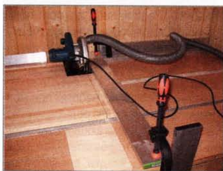
Для поперечных резов нужно использовать мелкозубый диск
