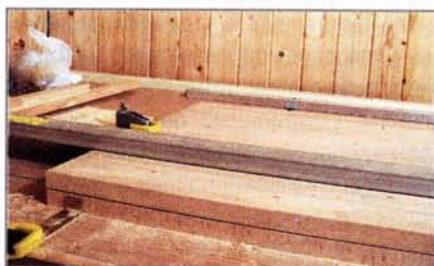
Простейший упор — уголок, прижатый к столу струбциной
