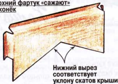
Рис. 5. V-образный вырез в фартуке на коньке
