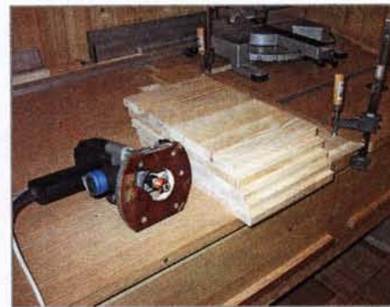
Снятие фаски фрезером
