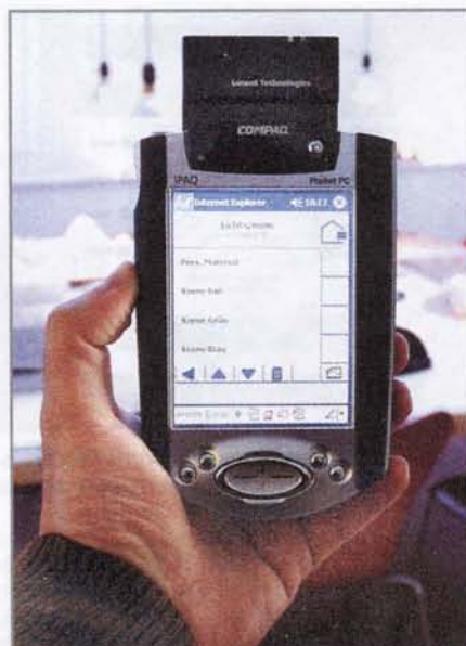
С помощью системы EIB—Instabus и домашнего компьютера можно управлять бытовой техникой через карманный персональный компьютер
