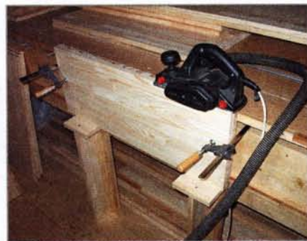
Обработка кромки рубанком
