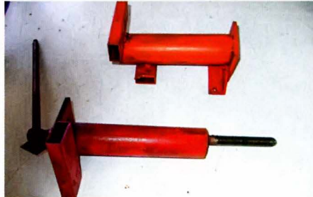
Подвижная и неподвижная части тисков.
