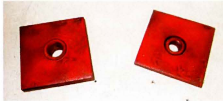
Заглушка неподвижной части тисков с вваренной гайкой М16 мм. Эта заглушка при помощи электросварки крепится к торцевой части внешнего цилиндра тисков
