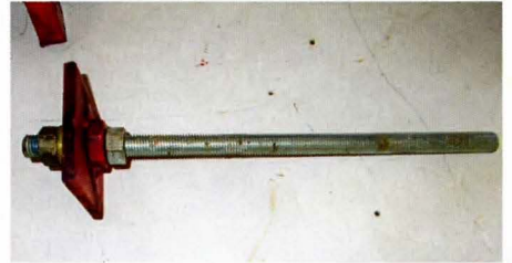
Резьбовая шпилька с фиксирующими элементами (гайками М20) на торцевом фланце
