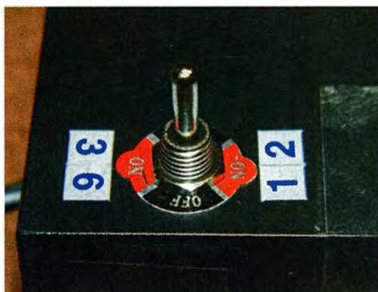
↑ На корпусе рядом с переключателем сделал две наклейки — «12» и «36», чтобы не перепутать мощность.
