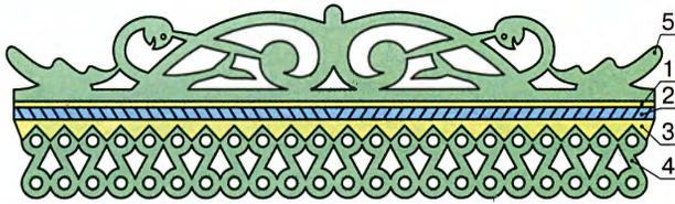
↑ Рис. 1. Верхняя часть наличника с прямым карнизом: 1 — навес; 2 — пояс резьбы; 3 — пояс пропильной резьбы с треугольными выемками; 4 — пояс сложной резьбы; 5 — навершие наличника.
