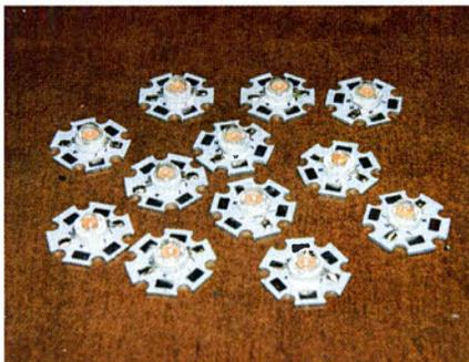
↑ Платы Star с напаянными полноспектральными светодиодами.
