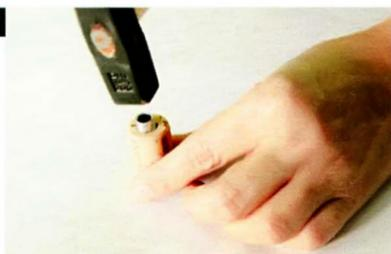
3 Теперь с помощью молотка закрепляем в пробке втулку для патрона.
