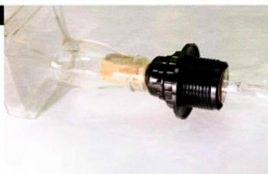
5 Закрепляем провод внутри патрона и прикручиваем сам патрон к втулке. Вставляем пробку в горлышко так, чтобы она сидела максимально плотно и не давала патрону двигаться в стороны.
