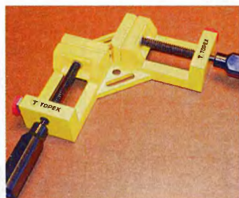
Угловая струбцина помогает зафиксировать детали под прямым углом друг к другу.
