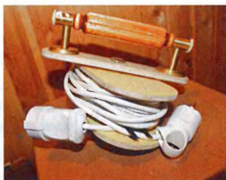
Катушка с установленной рукояткой — обычной дверной ручкой.
