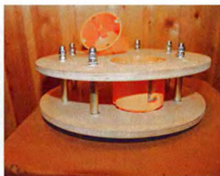
После сборки катушки соединительные коробки для розеток вставлены в подготовленные отверстия.
