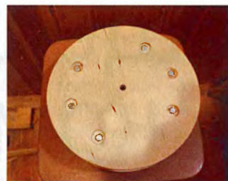
Головки болтов утоплены, чтобы поворотная планка с рукояткой не задевала их при вращении катушки.
