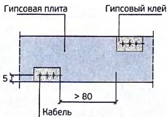
Рис. 4. Устройство электропроводки.
