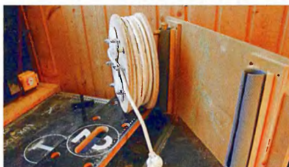
Рукоятка катушки надёжно фиксируется в держателе.
