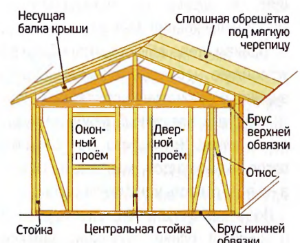
Рис. 4. Каркас передней фронтовой стены и крыши.
