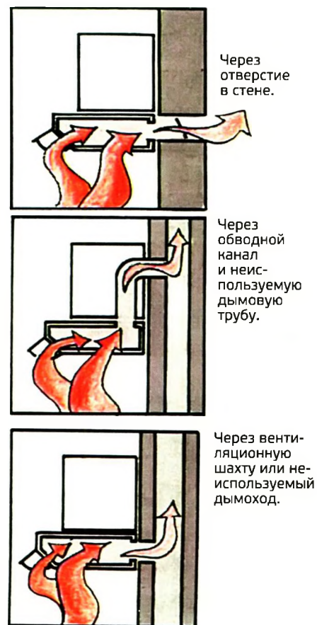
Рис. 1. Схемы удаления загрязнённого воздуха в атмосферу.
