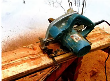
Дубовые доски простругали и распустили на плашки для отделки фасадов.
