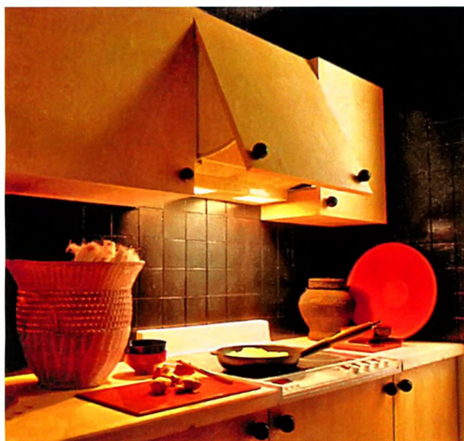
Встроенная вытяжка, соответствующая по форме и размерам настенному шкафу. При пользовании вытяжкой облицованную декоративным материалом лицевую плиту (дверку) откидывают вперёд. Чтобы выиграть пространство в шкафу, откидную дверку можно сделать двухсекционной. В этом случае освободившееся в шкафу место можно использовать, например, для хранения банок с пряностями.
