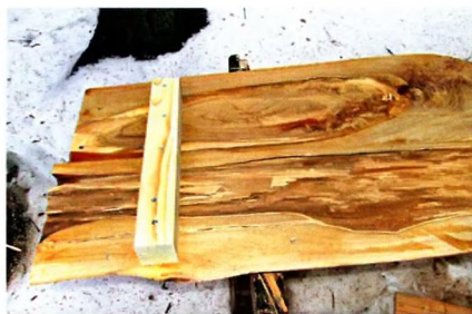
Столешницу из двух дубовых досок снизу скрепили брусками и саморезами.
