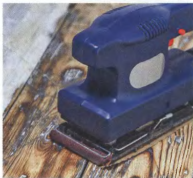
Деревянные полы можно обработать рубанком или шлифовальной машиной.
