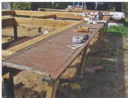
Верстак с пилой. Видны подставки перед инструментом и за ним.
