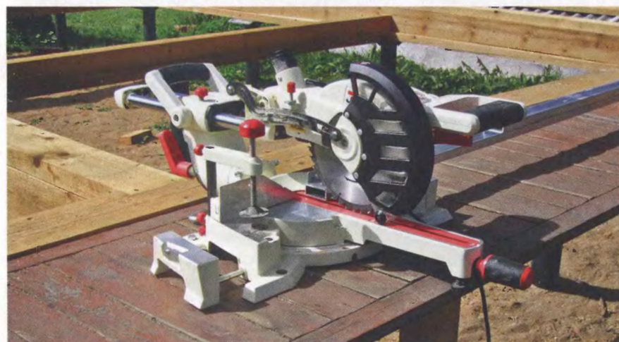
Диск опущен для точной фиксации профиля при монтаже упора.
