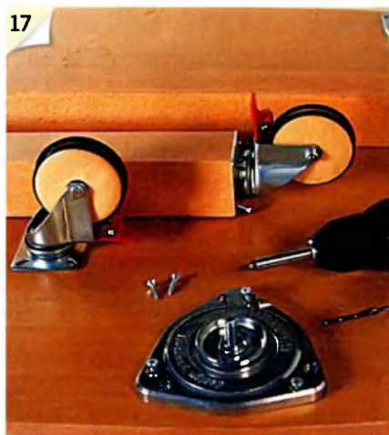
17 На концах ножек стола монтируют поворотные колёса. Затем сами ножки навинчивают на резьбовые шпильки несущих пластин.
