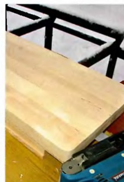
Окончательная доводка углов ленточной шлифовальной машинкой.
