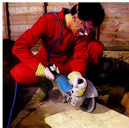
Несмотря на наличие у болгарки защитного кожуха, при работе с ней всё же необходимо надевать очки и респиратор.
