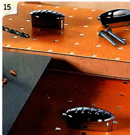
15 В дверках сверлят по два отверстия под винты, которые вставляют с тыльной стороны и винчивают в резьбовые отверстия ручек.
