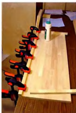
Сначала надо приклеить планку по фасаду столешницы.
