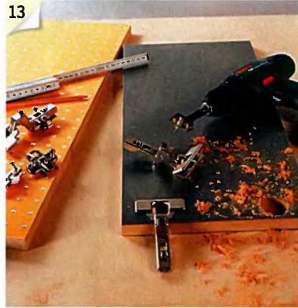
13 Гнёзда под пружинные мебельные петли выбирают сверлом Форстнера, предварительно разметив их положение.
