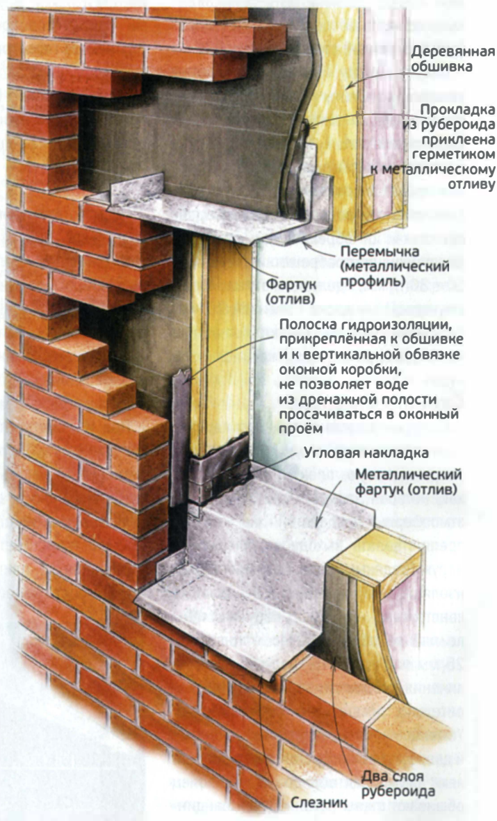
Рис. 2. Конструктивная гидроизоляция оконных и дверных блоков.
