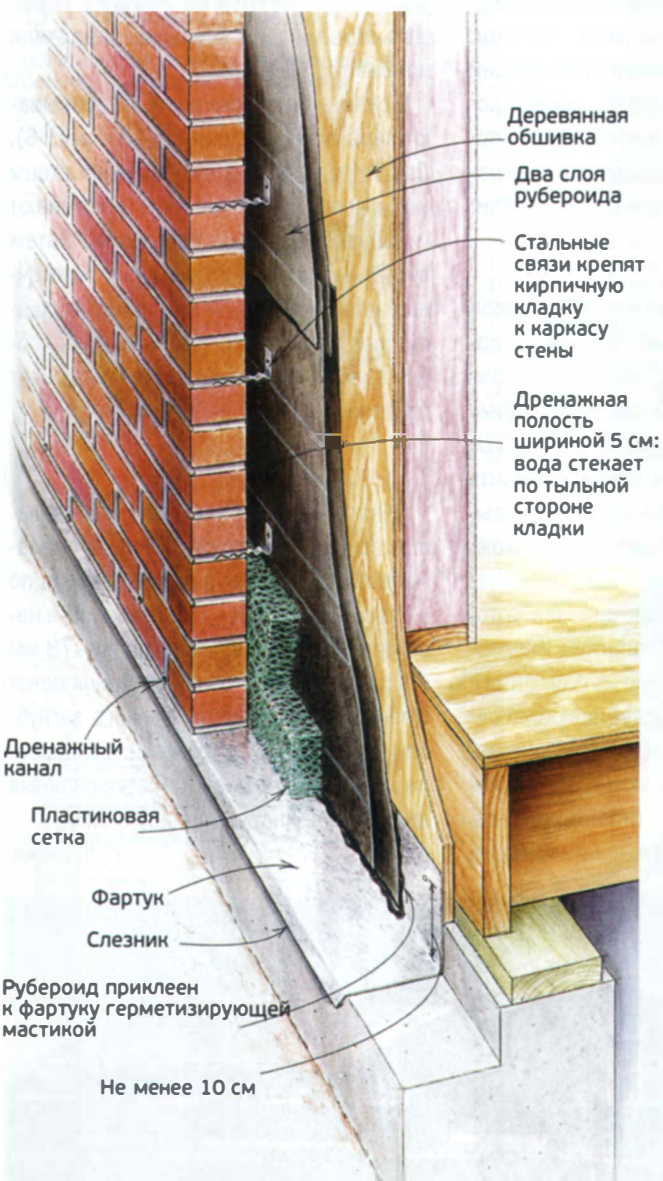
Рис. 1. Конструкция каркасной стены с кирпичной облицовкой.
