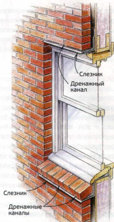
Рис. 6. Дренажные каналы располагают как поверх окон, так и под ними. Вода из дренажных каналов стекает на слезники фартуков.
