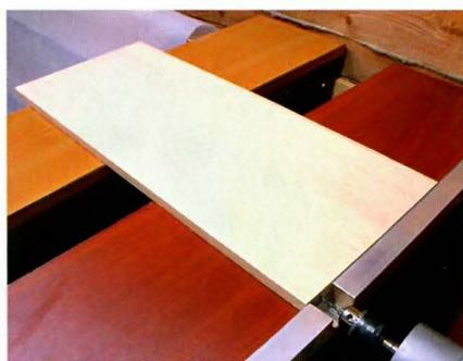
Засверливаем отверстия в торцах полок под саморезы  $\varnothing 3$  мм и под штоки эксцентриков  $\varnothing 7$  мм.
