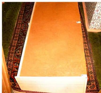
Установлена задняя стенка и дополнительные рейки внизу.
