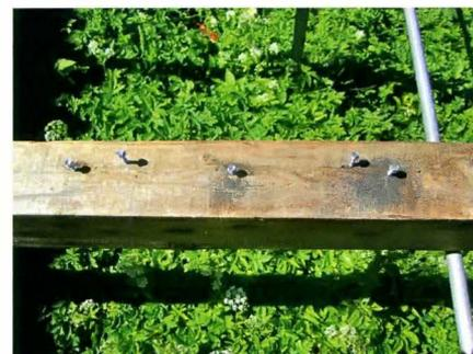
Для изготовления кондуктора для гибки хомутов понадобилось 5 саморезов  $\varnothing$  6 мм с широкой шляпкой и кусок деревянного бруса сечением 100 × 100 мм.
