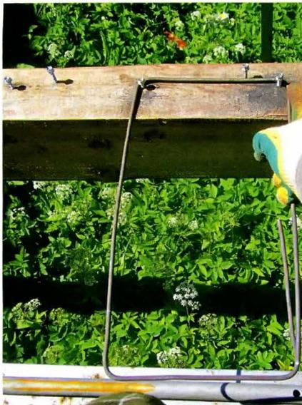
Правый и средний саморезы отвечают за формирование короткой стороны хомута. При использовании для изготовления хомутов проволоки  $\varnothing$  6 мм её можно гнуть вручную.
