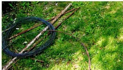
В качестве вязальной проволоки применяют низкоуглеродистую отожжённую сталь. После термической обработки она становится более гибкой. Вязальная проволока практически не тянется, что придаёт узлу дополнительную прочность.
