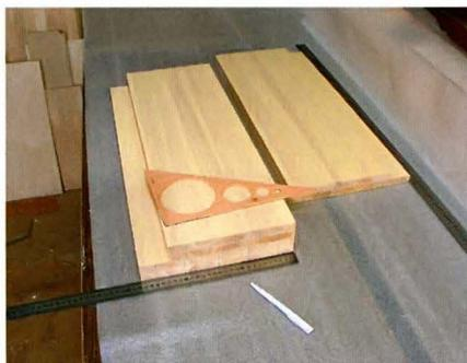
Размечаем отверстия на торцах полок. На каждую сторону нужно минимум три точки крепления.
