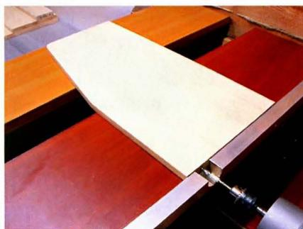
Сверлим в верхнем торце три отверстия под шток эксцентрика  $\varnothing 7$  мм для крепления козырька.
