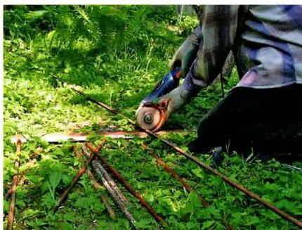
Если в хозяйстве нет болторезов, способных в одно мгновение перекусить закалённую арматуру нужного диаметра, то отрезать прутья необходимой длины поможет болгарка с отрезным диском по металлу.
