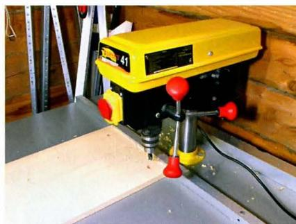
Ориентируясь по отверстиям под штоки, сверлим отверстия  $\varnothing 15$  мм под чашки эксцентриков.
