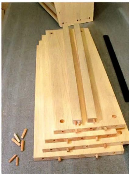
В торцах полок боковых секций шканты устанавливаем на клей.
