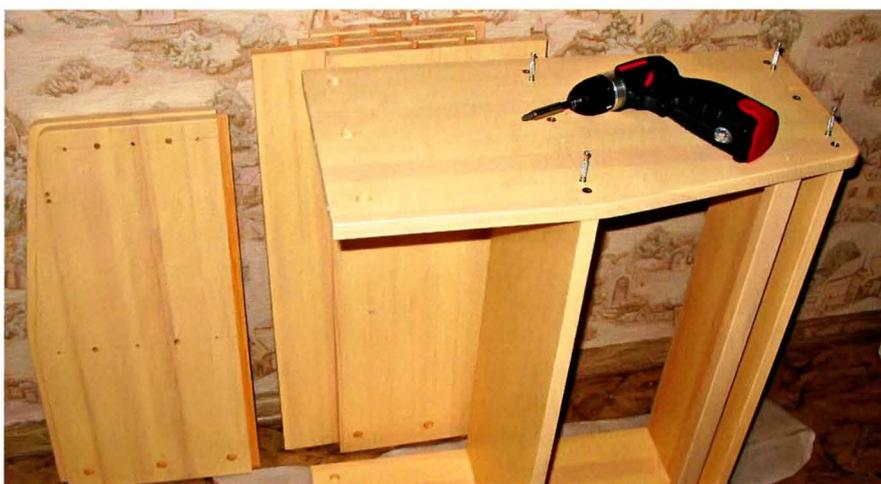
Закручиваем штоки эксцентриков в стойку средней секции.
