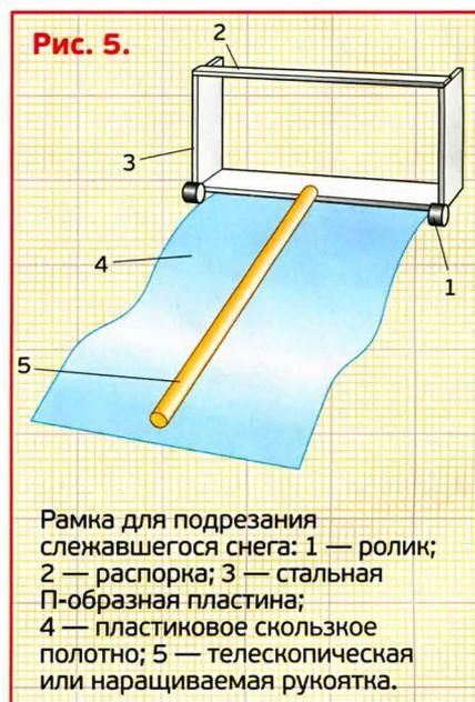
закреплённая перпендикулярно к оси ручки. На нижней части скребка — два ролика для предупреждения повреждения кровельного покрытия. Лезвие скребка заносят на слой снега, опускают в него и стягивают снег вниз.
