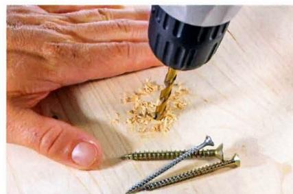
Перед вкручиванием шурупа следует просверлить отверстие, соответствующие его диаметру.
