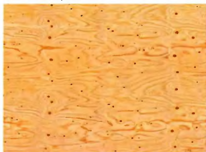
Хвойные древесные плиты имеют привлекательную текстуру, легки и довольно прочны.
