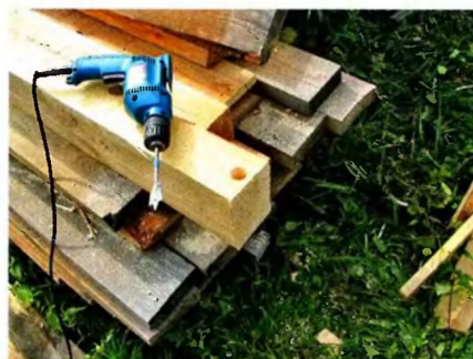
Чтобы изготовить паз, просверлим сквозное отверстие, а затем...
