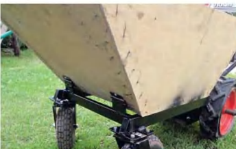
Фанерный бункер крепится к раме с помощью обычных дверных петель.
