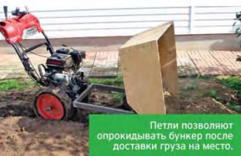
Фанерный бункер крепится к раме с помощью обычных дверных петель.
