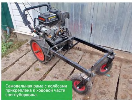
Рама из металлической профильной трубы сечением 20 × 40 мм с самоустанавливающимися колёсами.
