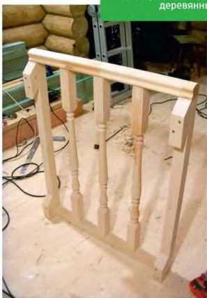
Своеобразный декоративный экран легко установить на место с помощью деревянных зацепов.
