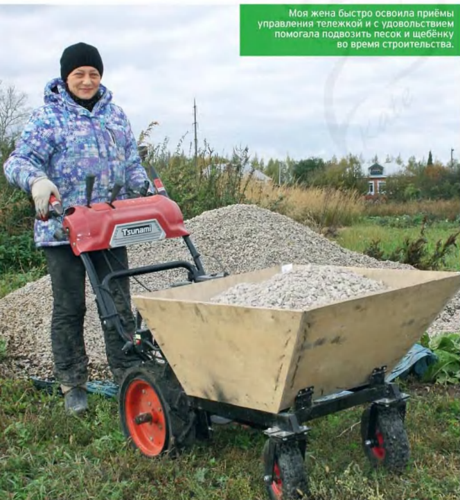
Петли позволяют опрокидывать бункер после доставки груза на место.
