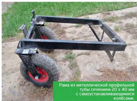
Самодельная рама с колёсами прикреплена к ходовой части снегоуборщика.
