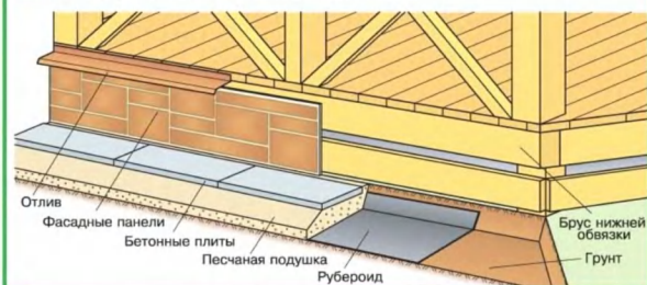
Рис. 1 УСТРОЙСТВО ЦОКОЛЯ ОТКРЫТОЙ ТЕРРАСЫ.
