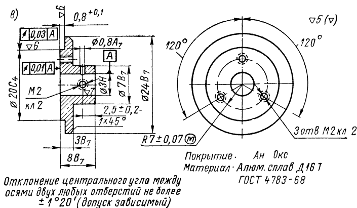
Рис. 50. Примеры конструктивного оформления втулок
