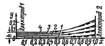
Рис. 6 Траектории электронов пучка толщины 2h в диоде. Здесь и на рис. 8 пунктирные линии — траектории электронов, влетающих через время t=30t_0 , сплошные — через t=60t_0 . Здесь и далее цифрами 1—4 обозначены номера траекторий V_1=1 , V_2=0,1 , j=2
