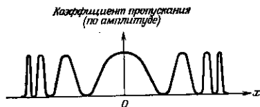
Фиг. 1.36. Профиль круглой синусоидальной решетки, коэффициент пропускания которой меняется как \cos^2 x^2 .
