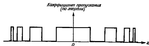
Фиг. 1.34. Профиль круглой решетки (решетка Сорэ, или зонная пластинка Френеля).
