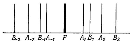
Рис. 89. Пространственный спектр двух фотографических изображений, многократно зарегистрированных на одной пластинке при смещениях пластинки между экспозициями, разных для каждого изображения.
