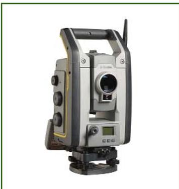
5". Тахеометры предлагаются в модификациях Autolock и Robotic.
