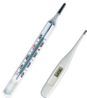
Рис. 123. Ртутный и электронный термометры
