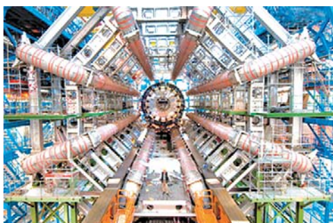
Рис. 134. Монтаж одного из детекторов коллайдера — «ATLAS»
