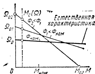
Рис. 14.30. Механические характеристики двигателя при различных значениях потока возбуждения
