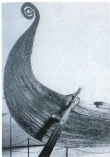
Кормовая часть ладьи из Усеберга с рулевым веслом. Музей Кораблей викингов. Осло. IX в.
