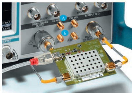
Рис. 18. Вид передней панели прибора R&S FSWP оснащенного входами для внешнего гетеродина (входы типа SMA обозначены символами А и Б)
