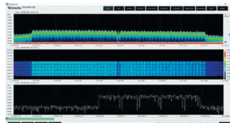
Рис. 3. Пакет видеоданных в диапазоне 5,8 ГГц, полученный после обработки сигнала I/Q
