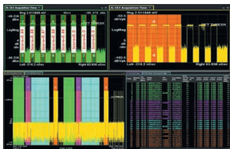
Рис. 7. Растровое сканирование показывает режимы работы и последовательности импульсов РЛС
