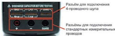
Рис. 4. Разъемы для подключения измерительных проводов
