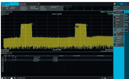
Рис. 4. Спектрограмма двух ИРИ 7 ГГц с ЛЧМ с полосой 1,5 ГГц и одним источником сигнала – генератором UXG
