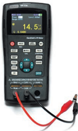
Рис. 7. Измерение индуктивности по 2-проводной схеме
