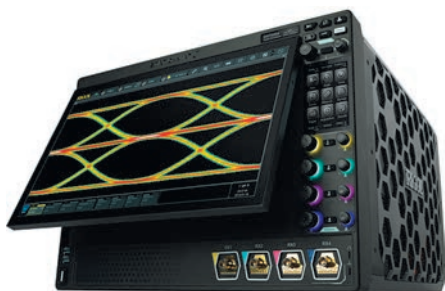
Рис. 13. Система Rigol Station MAX оборудована широким сенсорным дисплеем с регулируемым углом наклона
