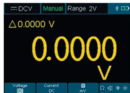
Рис. 11. Дисплей ADS-204x в режиме мультиметра
