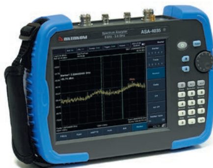
Рис. 2. Анализатор спектра серии ASA-40XX
