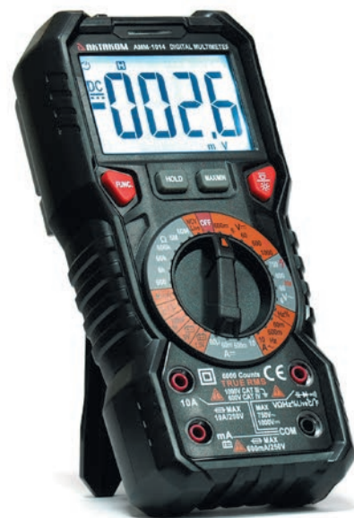
Рис. 3. Мультиметр АКТАКОМ АММ-1014
