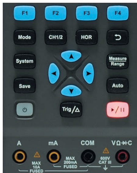
Рис. 5. Органы управления осциллографов серии ADS-204x
