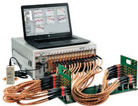
Рис. 4. Векторный анализатор цепей в формате PXI
