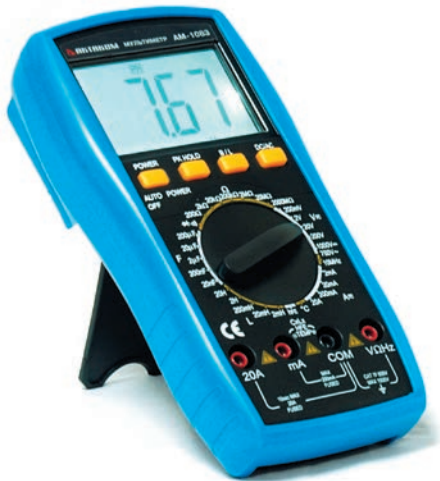
Рис. 4. Мультиметр AM-1083 в защитном чехле
