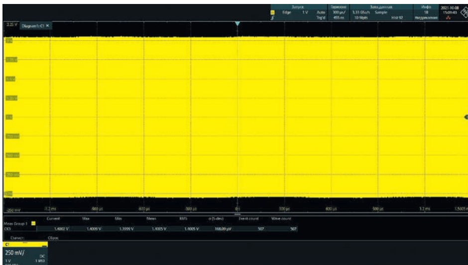
Рис. 11. Результат измерений среднеквадратичного значения напряжения ШИМ на периоде модулирующего сигнала
