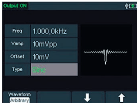
Рис. 12. Дисплей ADS-204x в режиме установки параметров генератора
