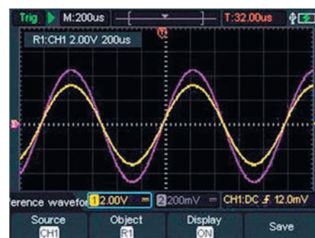
Рис. 9. Загруженная опорная осциллограмма в осциллографах серии ADS-204x
