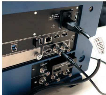
Рис. 8. Фотография внешних интерфейсов генератора R&S RTO6-B6
