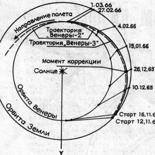
Рис. 1. Схема полета станций «Венера-2» и «Венера-3».
