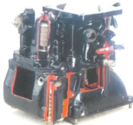
Бесплоплавковые карбюраторы поршневых авиадвигателей
