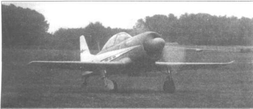
пользовали маслосистему и другие агрегаты силовой установки Як-18ПМ. Основные стойки шасси "Кванта" представляли собой доработанные опоры Як-18П. Хвостовая стойка - с "Тренера" Z-326. В процессе детальной проработки, к сожалению, пришлось отказаться от ее уборки.
