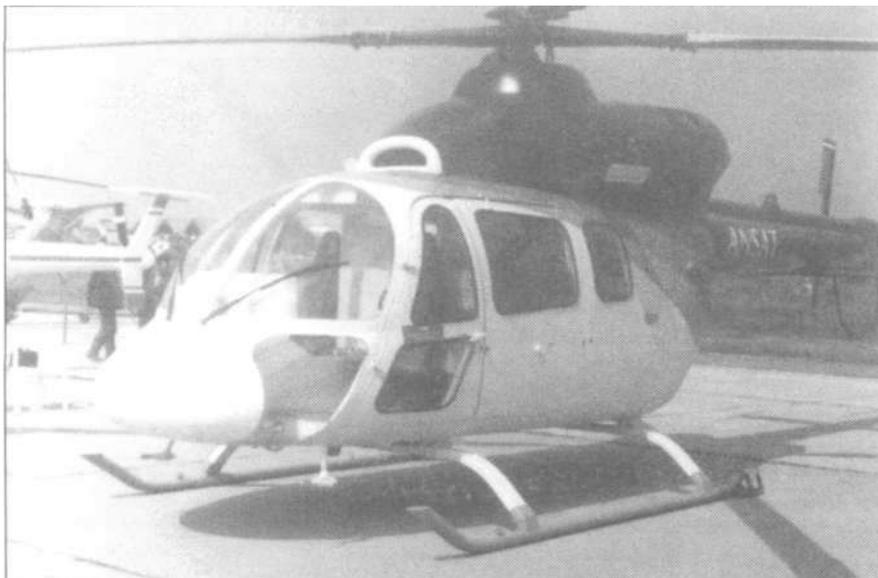
Макет «Ансата», предназначенный для статических испытаний.
