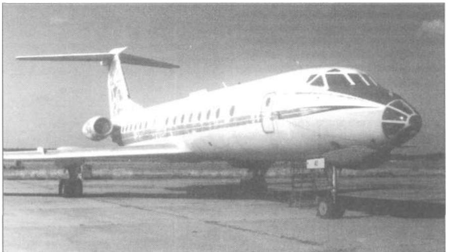
*Салонный вариант Ту-134, оснащенный аппаратурой спецсвязи «Балканы» с характерной антенной в хвостовой части фюзеляжа, иногда называют штабным.*
