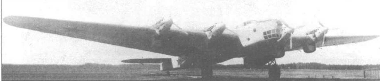
ДБ-А войсковой серии с двигателями АМ-34ФРНТК
