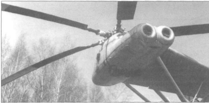
Мотогодола В-12 в походном положении (вверху). В случае необходимости нижние крышки капотов превращались в мостки (внизу) для обслуживания силовых установок.
